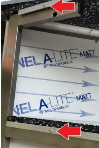
Die beiden Arbeitsflächen der Eckgestelle mit je einer Schraube links und rechts (= pro Gestell 4 Schrauben) festdrehen.
